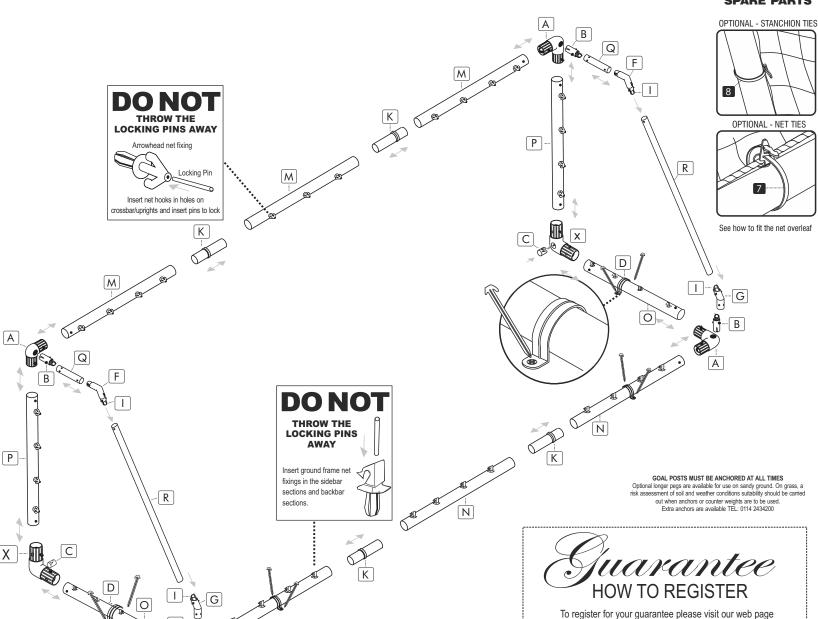
**COMPONENTS** (A) ×4 CORNER BRACKET CORNER BRACKET UPRIGHT 4 HOLES В SPIGOT BLANKING CAP **×4** D MULTI-SURFACE ANCHOR **x8 GROUND PEG** STANCHION ELBOW LOWER BACK STANCHION **x**2 LARGE QUICK RELEASE ×12 SMALL QUICK RELEASE BUTTON **x8** ×18 NET TIE STRAIGHT CONNECTOR ARROW HEAD NET FIXING GROUND FRAME NET FIXING \*20 NH
